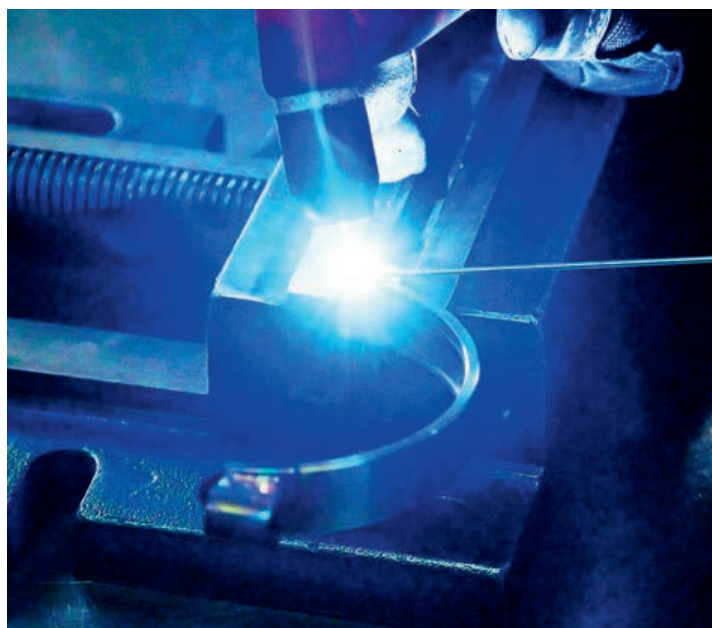
Dankzij een digitale sturing worden de eigenschappen van de vlamboog als het ware softwarematig beschikbaar en kan er diep in het lasproces ingegrepen worden
