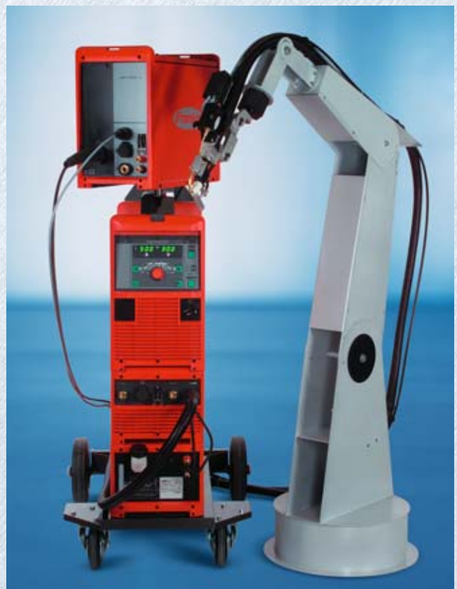
MagicWave 5000 en robotlastoorts Robacta TTW 4500 met koude-draadtransport-unit Robacta KD-Drive
