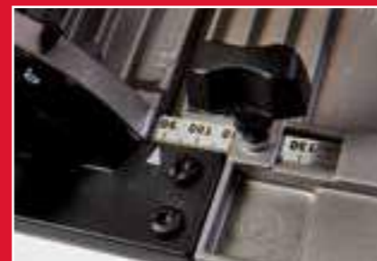
Dubbel verankerde geleider aan de voor- en achterzijde van de machine
